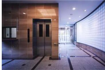
エントランスホールと、駐車場との境の壁面を僅かに曲面とし、床から天井までをガラスブロック積みの光壁面とした。こうすることで、空間的な広がりが得られた上に、昼間は駐車場を通して外部の光が柔らかく内部に注ぎ、気持ちの良いエントランスホールとすることに成功した。夜間は逆に内部の照明が駐車場の入り口帯を照らし、運転者の気持ちを和ますことになる。
